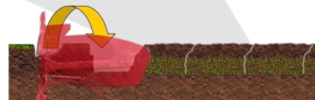
Labour agronomique (13-15 cm) avec une charrue Demblon équipée Mixte Bio
