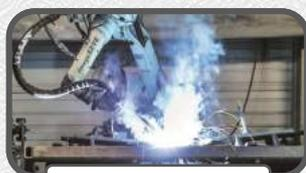
Robots de soudure
