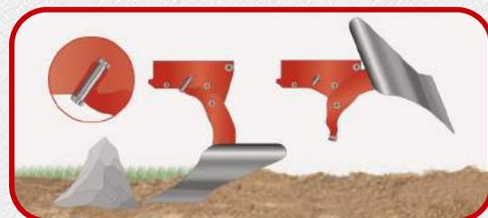
ÉLONGATION - RUPTURE DU BOULON
