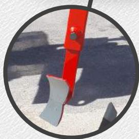
Vis de réglage de la profondeur de travail des rasettes.
