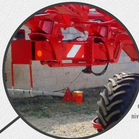
L'extension fixée par boulons peut être démontée aisément. Un coupleur hydraulique rapide facilite le débranchement de la sécurité sur les modèles NSH, et la prise de courant de la rampe de signalisation se situe au niveau du corps précédent.
