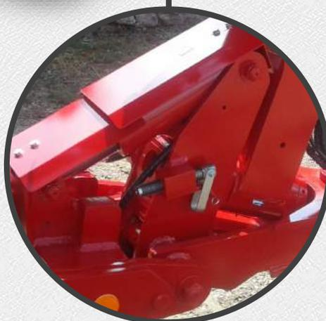
2 Vis de butée pour le réglage sans outil de la profondeur de travail au niveau de la roue.
