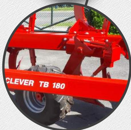
Butées de réglage de la profondeur de travail au niveau
