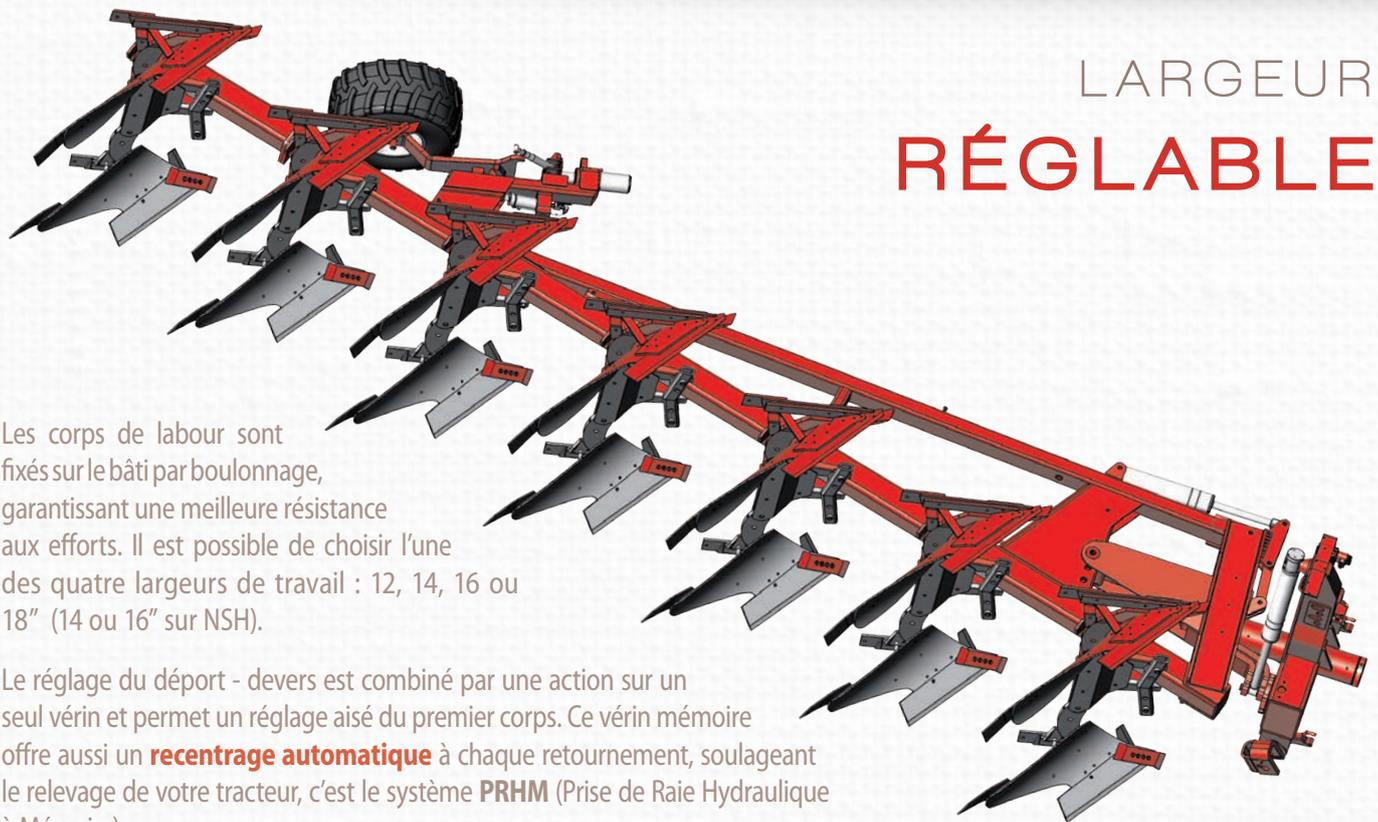
Les corps de labour sont fixés sur le bâti par boulonnage, garantissant une meilleure résistance aux efforts. Il est possible de choisir l'une des quatre largeurs de travail : 12, 14, 16 ou 18" (14 ou 16" sur NSH).
