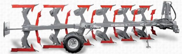
Le soc forgé renforcé est l'outil idéal pour les terres collantes ou pierreuses, le soc à pointe réversible pour tous types de terres, le soc à pointe mobile pour les conditions difficiles et le soc à pointe au carbure pour limiter les effets de l'usure.
