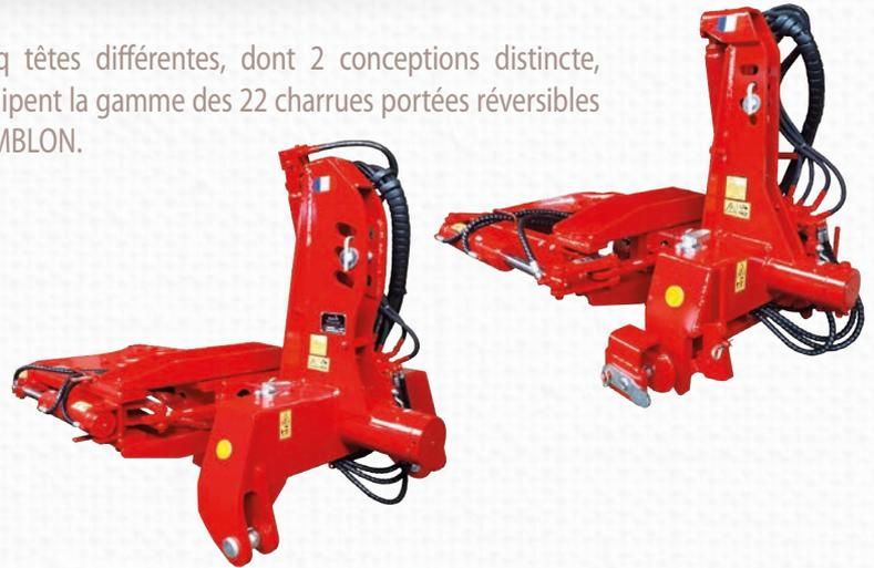
Celle-ci pivote au contact de deux bagues en polyamide qui ont une forte capacité de résistance à la déformation et à l'usure malgré la charge. Seul un graissage régulier est nécessaire pour l'entretien. L'écamoussure, mécano-soudée, assure une liaison robuste de la tête avec le châssis.
